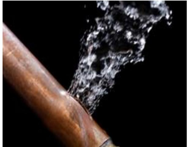
Esta sobrepresión en red provoca averías en las zonas más débiles, roturas en filtros de fuentes de agua, saltos de las válvulas de seguridad de los termos eléctricos, aumento del salpicado de los grifos temporizados diseñados para una presión menor...
